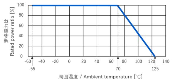
周囲温度が70°Cを超える場合は、上図の軽減曲線に従って定格電力を軽減して下さい。
