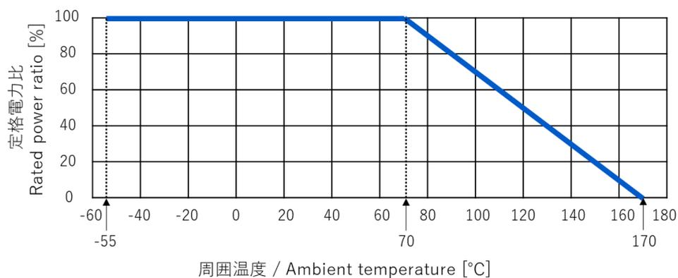
周囲温度が 70°C を超える場合は、上図の軽減曲線に従って定格電力を軽減して下さい。
